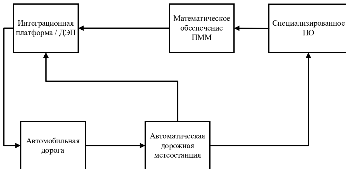
Рисунок 1 - Пример блок-схемы локальной ПММ
