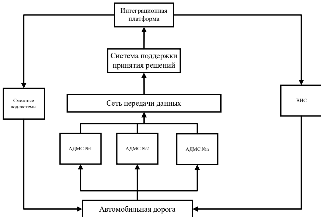
Рисунок 2 - Пример блок-схемы распределенной структуры подсистемы метеомониторинга
